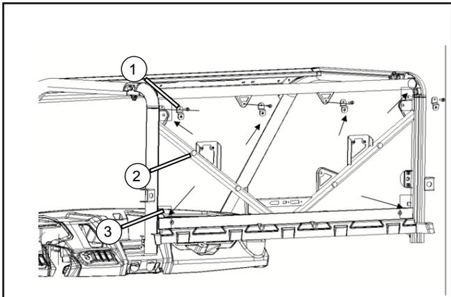
Installez les plaques de fixation supérieures **(1)** comme sur l'illustration de gauche, installez et pré-verrouillez les vis, puis collez le coussins **(2)**, et collez les patins en caoutchouc **(3)** sur quatre coins.
